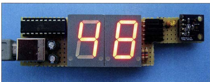
Bild 1: Hygrometer mit einem HDC1080-Modul; die Verdrahtung mit isolierten Drähten erfolgte auf der Unterseite der Universalplatte.
