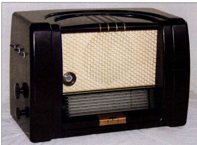
Bild 1: Der Empfänger Noravox W676 – hier ein Gerät in fast neuwertigem Zustand – hat neben Mittelwelle auch fünf KW-Amateurfunkbänder. Er wurde Anfang der 1950er-Jahre in geringer Stückzahl gefertigt.
