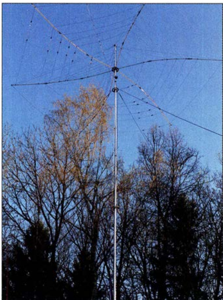
Bild 1: 12 m langer Aluminiummast mit faltbarem 6-Band-Hexbeam von Folding Antennas Fotos: DL3SBP
