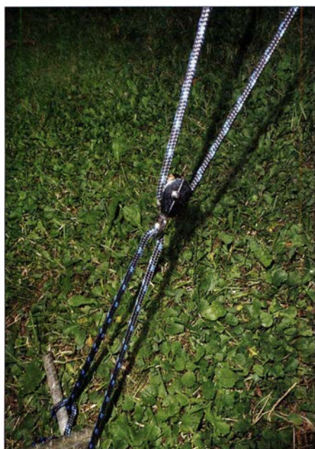
Bild 6: Umlenkrolle am Abspannpunkt abseits des Mastfußes
