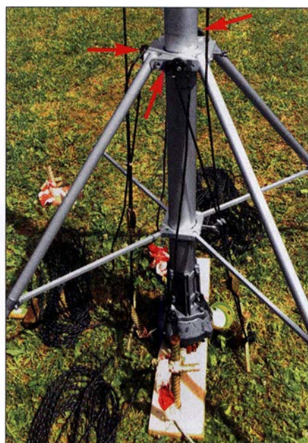
Bild 8: Am Maststativ sind oben drei Schotklemmen befestigt, siehe Pfeile.
