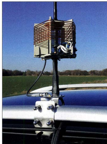
Bild 2: Mobilstrahler für 40 m und 20 m mit automatischer Umschaltung an der Dachreling befestigt Foto: DL9OBL
