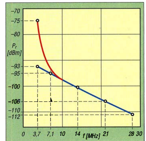
Bild 15: Grundrauschpegel des Empfängers an der Hy End Fed-Antenne; Messwerte mit Mantelwellensperre (blau) und ohne (rot)
