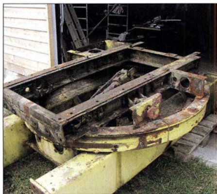
Bild 2: Der Drehkranz eines T174-Baggers bildet die mechanische Basis der gesamten Anlage.
