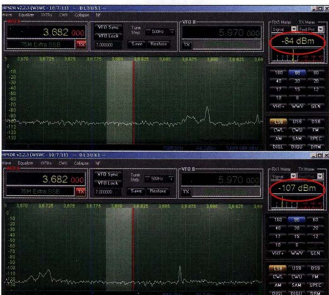
Im Ergebnis einer zeitweiligen Stromabschaltung im Wohngebiet bei DL3UXI sank der breitbandige Rauschpegel im 80-m-Band von -84 dBm (≈S7) um 23 dB auf -107 dBm (etwas über S3).
